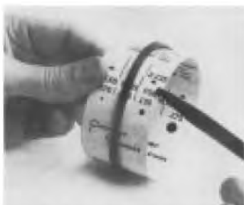
用测量带识别O形圈规格
